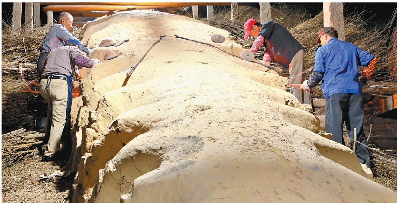
前墅龙窑的窑工们正在用竹枝烧窑。
