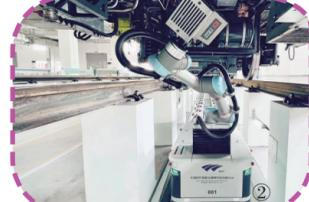
上。作为日常巡检的“新人”，智能车辆巡检机器人平稳驶入列车底部，灵活调动“长臂”，转动“大眼睛”，对关键检修点拍照并自动确认“健康状况”(图②)。据悉，该“检修黑科技”配合动态图像检测系统，可实现精扫检测、故障识别预警，检测数据将实时发至地面数据中心，最大化覆盖地铁车辆检修范围。“两台智能车辆巡检机器人只需两个小时，就能完成六个股道的车辆检修工作量，极大提高了检修效率和可靠性。”车辆设备部检修四车间车辆工程师季冰杰介绍。
