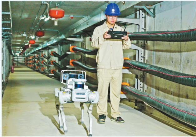
峰度夏期间，这些“数字员工”的巡检频次提升至日常的2倍，每月节约人工巡检时长800多小时。今年以来，已有效发现设备外观类及测温缺陷26条。国网无锡供电公司相关负责人透露，接下来将聚焦多项“黑科技”
