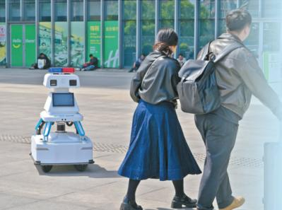
中央车站二楼户外平台安防巡逻机器人“小安”可按照设置的地图进行巡检,能对垃圾桶进行烟感检测、对充电区域进行红温度监测等。同时,它还具备语音交互功能,能为旅客提供路线指引、公共交通信息查询等服务。
