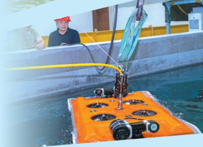
无锡蓝启智能科技有限公司自主研发的新型高效智能水下清洗机器人,集潜水、自主水下巡检、清洗等功能于一体,可在不停产的情况下实现船舶、水下大件或固定物体的高效清洗。
