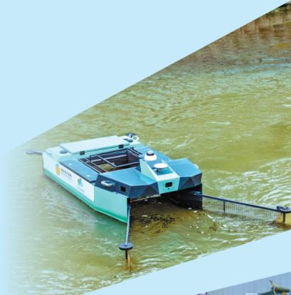
经开区投用无人驾驶清洁船定期在河道里巡逻,该设备搭载先进智能导航系统,配备多重避障传感系统,可精准识别水面漂浮物,自主完成巡回作业,实现24小时全天候保洁,极大提高清洁效率。
