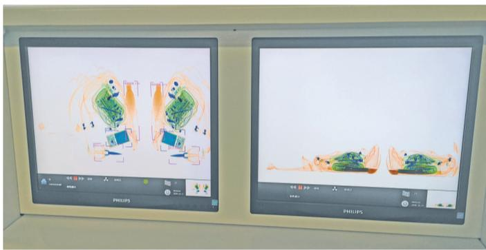
品,安检仪的显示屏上会出现一个“红框”提示,这时需安检人员肉眼比对判断甚至开箱检查。新的安检仪增加了图像识别,使用顶尖物质识别技术,实现360度无死角出图,能高效分辨出是什么危险品,并在图像显示上赋予不同颜色。
