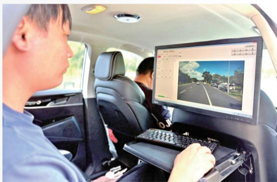
本报讯 车顶的激光测控器如“智慧听诊器”精准捕捉路面的细微病害，车头的摄像头则似“电子眼”实时观测前方路况……昨天下午，在锡山区胶阳中路上，一辆外观独特的农村公路自动化检测车打着双闪，正有序作业。车轮经过的每一寸路面的情况，都化作精准的数据，存入了“公路医生”的“大脑”，从细小裂缝到道路车辙，公路病害无处遁形。
