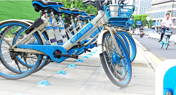
在锡城一处非机动车道上,设置了一定数量的“蓝牙道钉”,通过高精度识别和提示,引导共享单车用户规范停入规定区域内。
