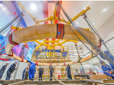
中核集团核工业西南物理研究院的工作人员在安装调试中国环流器二号M装置时起吊线圈(2019年9月16日摄)。
