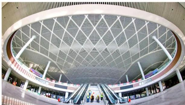
律。外幕墙曲线圆顺、接缝平滑,外观犹如起伏的波浪,象征江阴宛如巨轮乘风破浪,候车大厅入口处采用环形设计,似是寰宇囊括星芒,迎接八方来客。候车厅菱形吊顶采用全国首创剪纸工艺,将渐变的菱形铝板折边剪切,形成疏密变化,顶面双曲弧形灯半隐半透,充满轻盈流动的空间感。立面玻璃幕墙总面积近35000平方米,简洁明亮、视野开阔,与白色铝板幕墙衔接,展现出江头海尾之地域风情。
