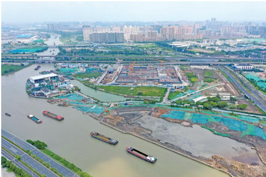
段。改线后的锡澄运河新航道途经梁溪区，按三级航道标准进行整治，航道口宽70米，设计水深3.2米，需开挖土方约70万方。
