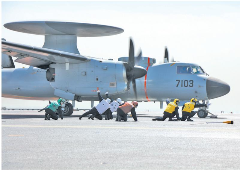
空警-600舰载预警机在福建舰上电磁弹射起飞, 起飞助理做出放飞手势(资料照片)。
