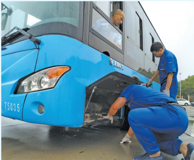
本报讯 方向、制动、灯光、供电等重要设备性能，车厢内扶手、栏杆、座椅牢固程度，车辆灭火器、逃生锤配置……这些既是公交车上关乎安全的设施，也是车况“体检”的重要内容。昨天，在市公交集团新城分公司新城营运部停车场，修理员乔征伟正和同事们一起冒雨对128路公交车一级部位做检查(上图)。据介绍，根据市交通运输局紧急部署，全市近3000辆公交车现已紧急启动“大体检”，坚决杜绝隐患车辆上路运营。
